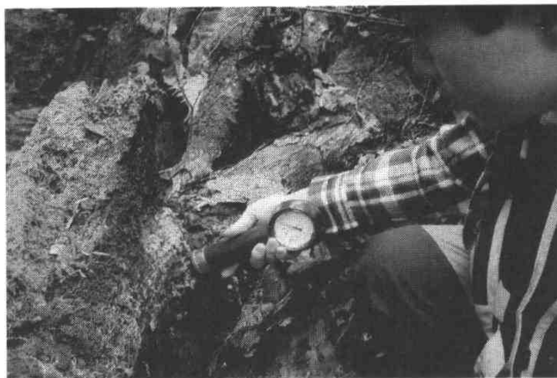
図3 材の硬さを調べる
