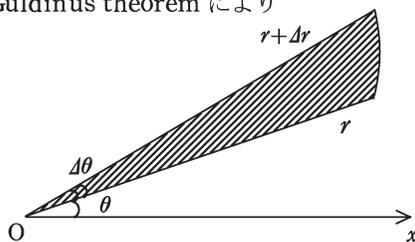
② 何と簡単。x 軸方向に積分しようとする、回転の外側、内側の区別が複雑で対応困難に。また、 $\theta$  が  $\frac{\pi}{2}$  を超えるかどうかで状況が大きく変化することも困難な要因に。なお、 $0 \leq \alpha < \beta \leq \pi$  の条件は区間が回転軸に跨らないことにも効いている。ただし、証明に Pappus–Guldinus theorem を用いたので、これの特殊な三角形版を次章で証明しておく。
